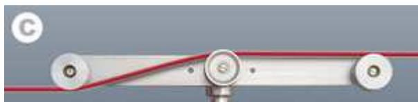
Das zu messende Material wird unter die erste äußere Materialführung, dann über den Kraftfühler und über die zweite Materialführung geführt.
