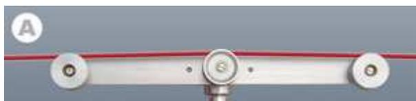
Das zu messende Material läuft über den Kraftfühler und die Materialführungen.
